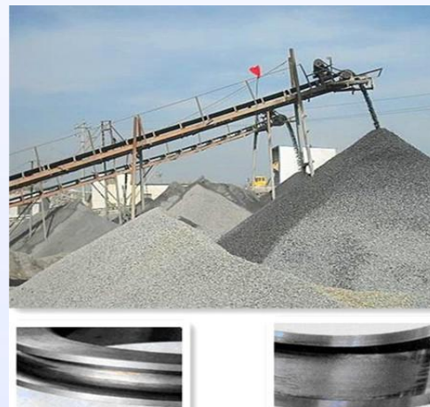
颗粒粉尘造成的轴承磨损失效
